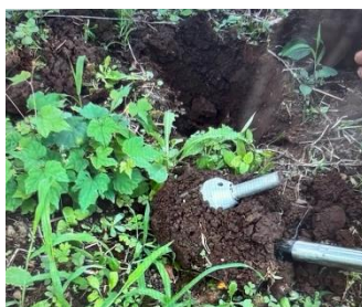
6 スコップで回りの土と一緒に採土缶を掘り起こす
