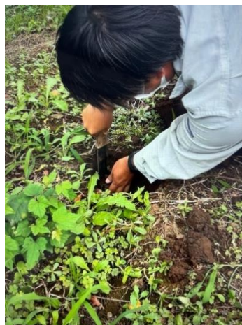
2 穴の側面の土を一部取り除く
