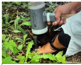
5 採土缶が埋まるまで採土補助器をハンマーで打つ
