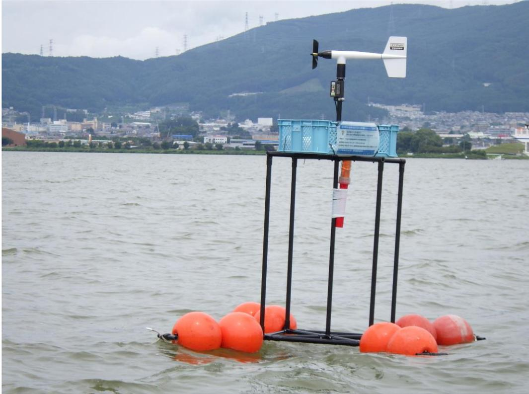
写真 2.1(1) 風向風速計の設置状況(湖心)
