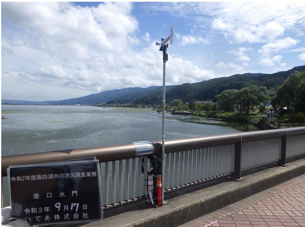
写真 2.1(4) 風向風速計の設置状況(釜口水門)
