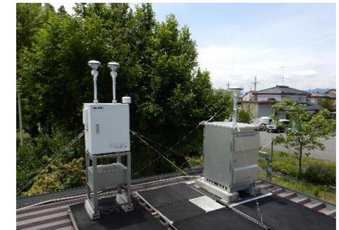
微小粒子状物質（PM2.5）の採取装置と自動測定機
