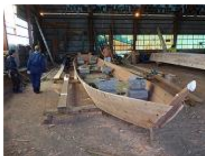
【 舟の立て板をつける作業 】
