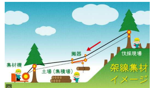
【架線集材の仕組み】
