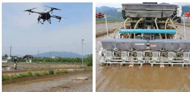
農業用ドローン（左）、乗用播種機（右）を用いた水稻種子の播種作業
