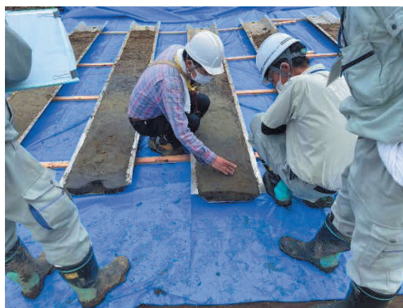
2-1-(1)-1 長野市長沼城跡におけるジオスライサーによる土層断面と確認作業
