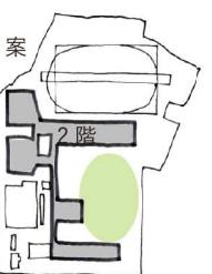
C案は複数の校舎を分散配置させるもので大体育馆等との接続した関係や、内外の活動の連続性を作ることを可能とするが隙間での工事工程となるため、安全確保や工期に懸念が生じる。校舎ボリュームが細長くなるため廊下状の動線が多くなり、避難やバリアフリー上の措置が必要となる。
