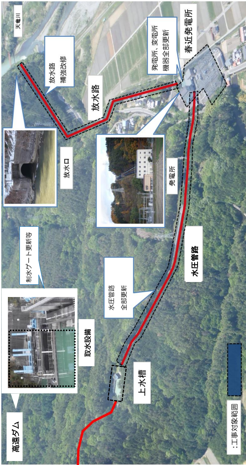
図—2.10 春近発電所 工事対象施設
