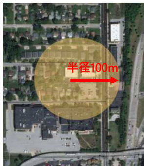
半径100mの範囲で漏水可能性エリアを特定
