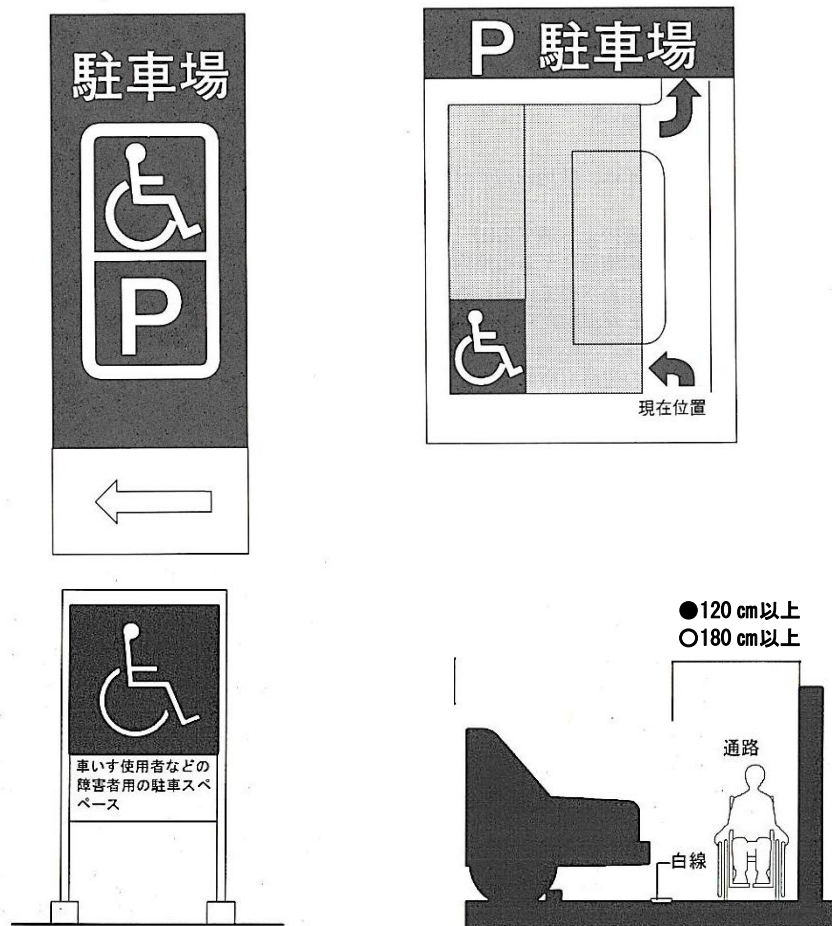
車いす使用者用駐車施設を設置した旨の表示例 図-30
