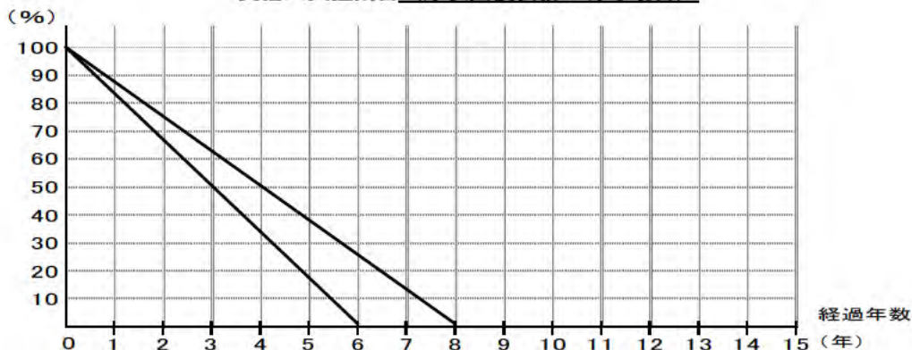
図3 設備等の経過年数と賃借人負担割合(耐用年数6年及び8年・定額法の場合) 賃借人負担割合(原状回復義務がある場合)
