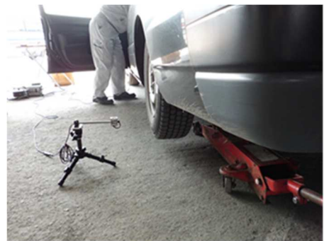
光電式回転数計によるタクシーメーター装置検査
