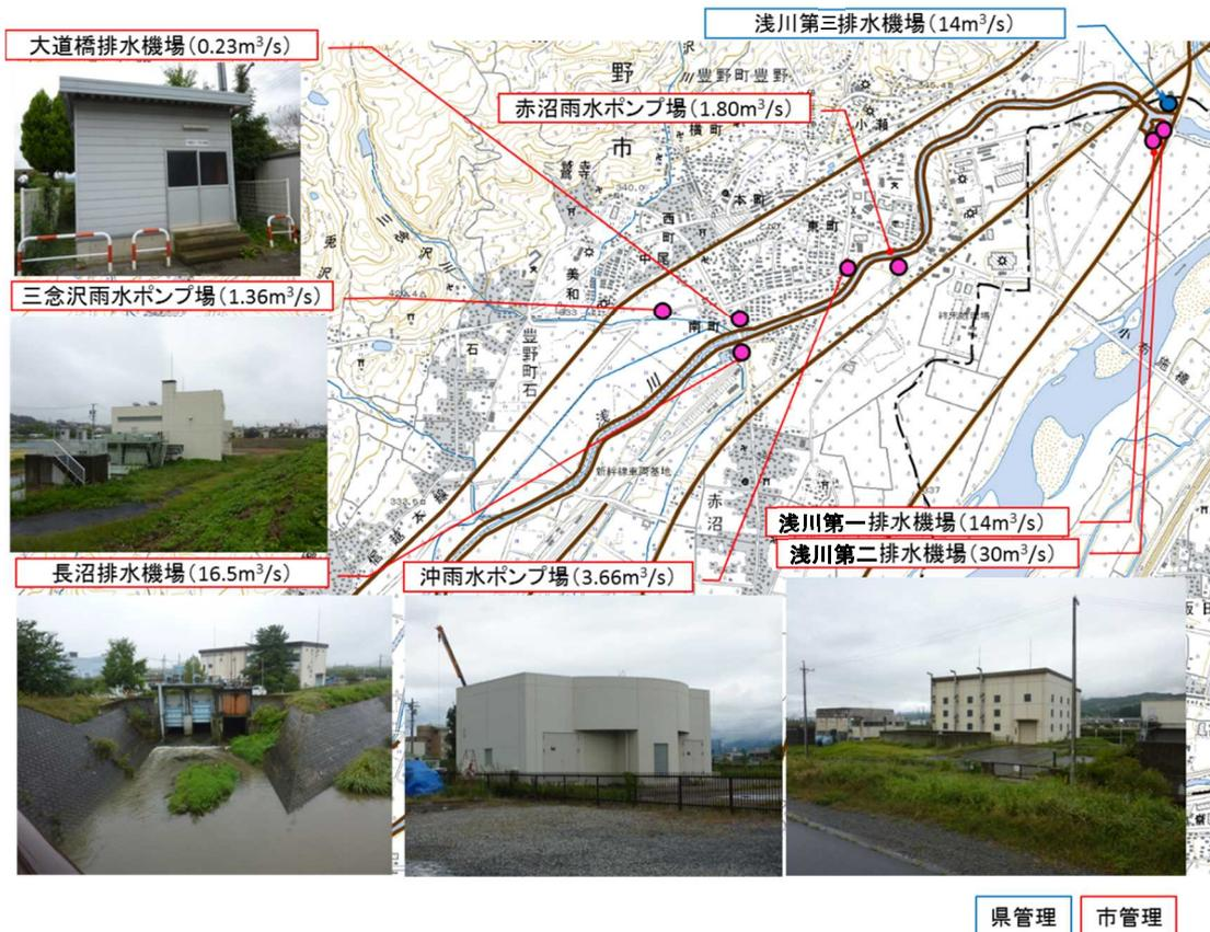
図 2.8.2 対象区域の排水機場・雨水ポンプ場設置状況
