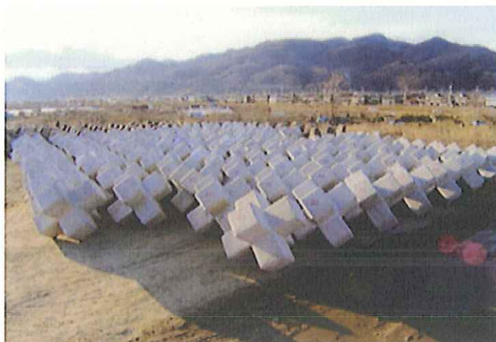
緊急対策用ブロックの備蓄
