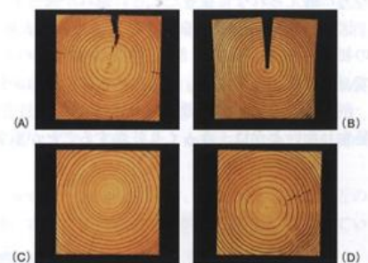
(A) 天然乾燥材：1材面あるいは複数面に必ず割れが入ります。(B) 青割り材：表面割れを防ぐためあらかじめ1材面に鋸溝を入れておきます。(C) (D) 高温乾燥材：乾燥方法により内部割れが発生することがありますが、表面割れは天然乾燥に比べ非常に少なくなります。
