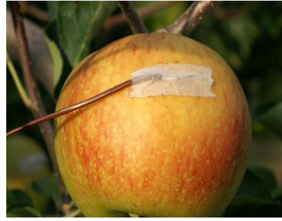
図 9 果実温度変化をセンサーで測定し、日焼け発生程度に及ぼす影響を調査
