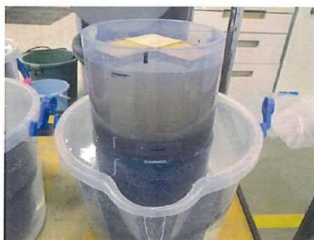
泥水被膜後の透水試験中
