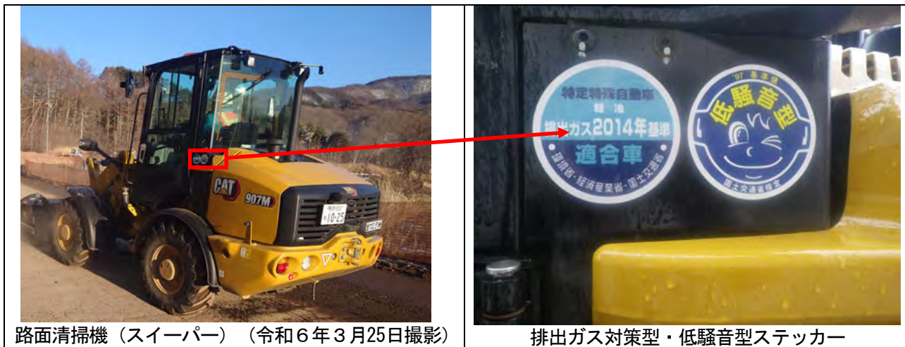
写真4-7(2)：排出ガス対策型・低騒音型建設機械の使用状況
