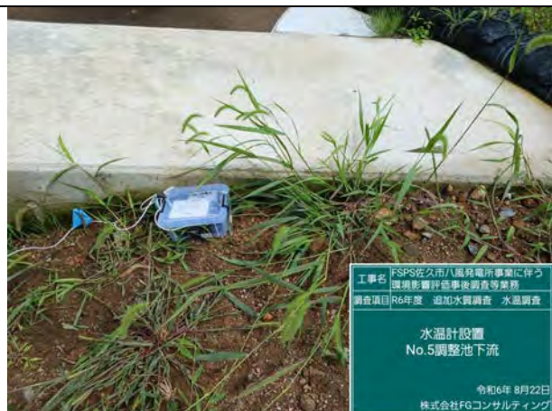
No.5 調整池下流での水温計の設置状況 (令和6年8月22日撮影)
