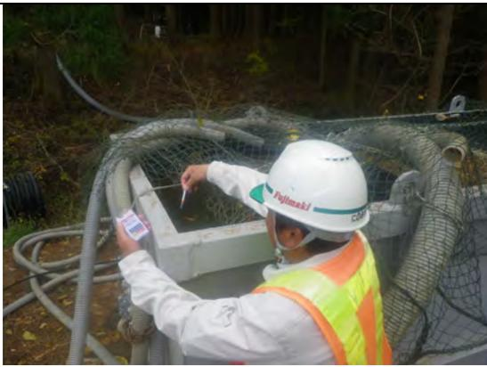
No. 7 調整池脇の簡易処理水槽での測定状況
