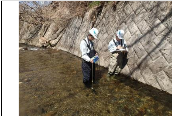
流速計による流量調査
