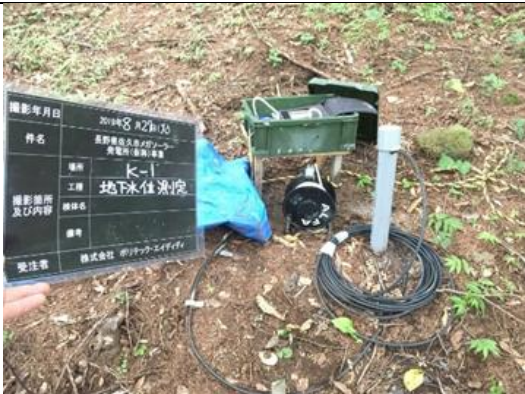
観測井の水位調査（自記式水位計）
