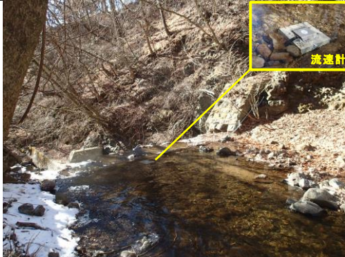
自記式流速計による流量連続調査
