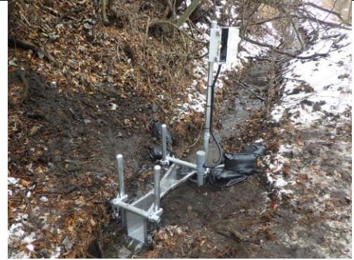
パーシャルフリューム式流量計による流量連続調査
