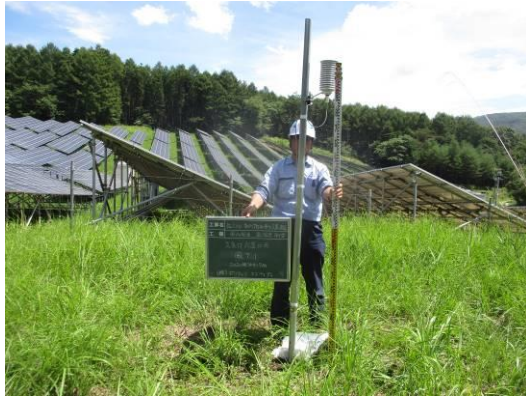
気温・湿度 (太陽光パネル設置場所の近傍)
