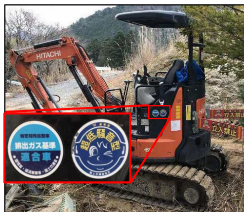
写真① 排出ガス対策型、低騒音型バックホウ
