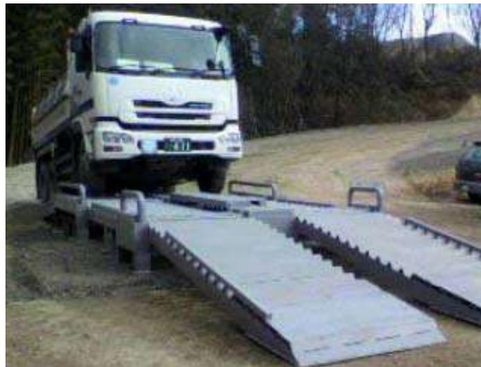
写真② タイヤ洗浄機の設定
