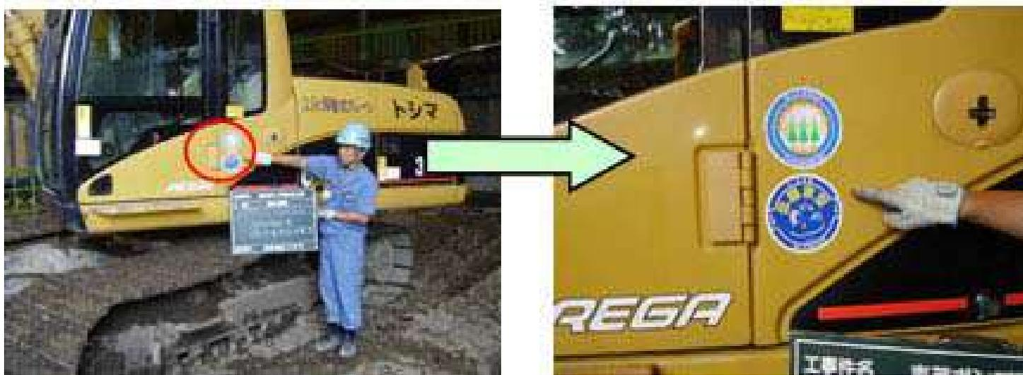
写真① 排出ガス対策型、低騒音型建設機械
