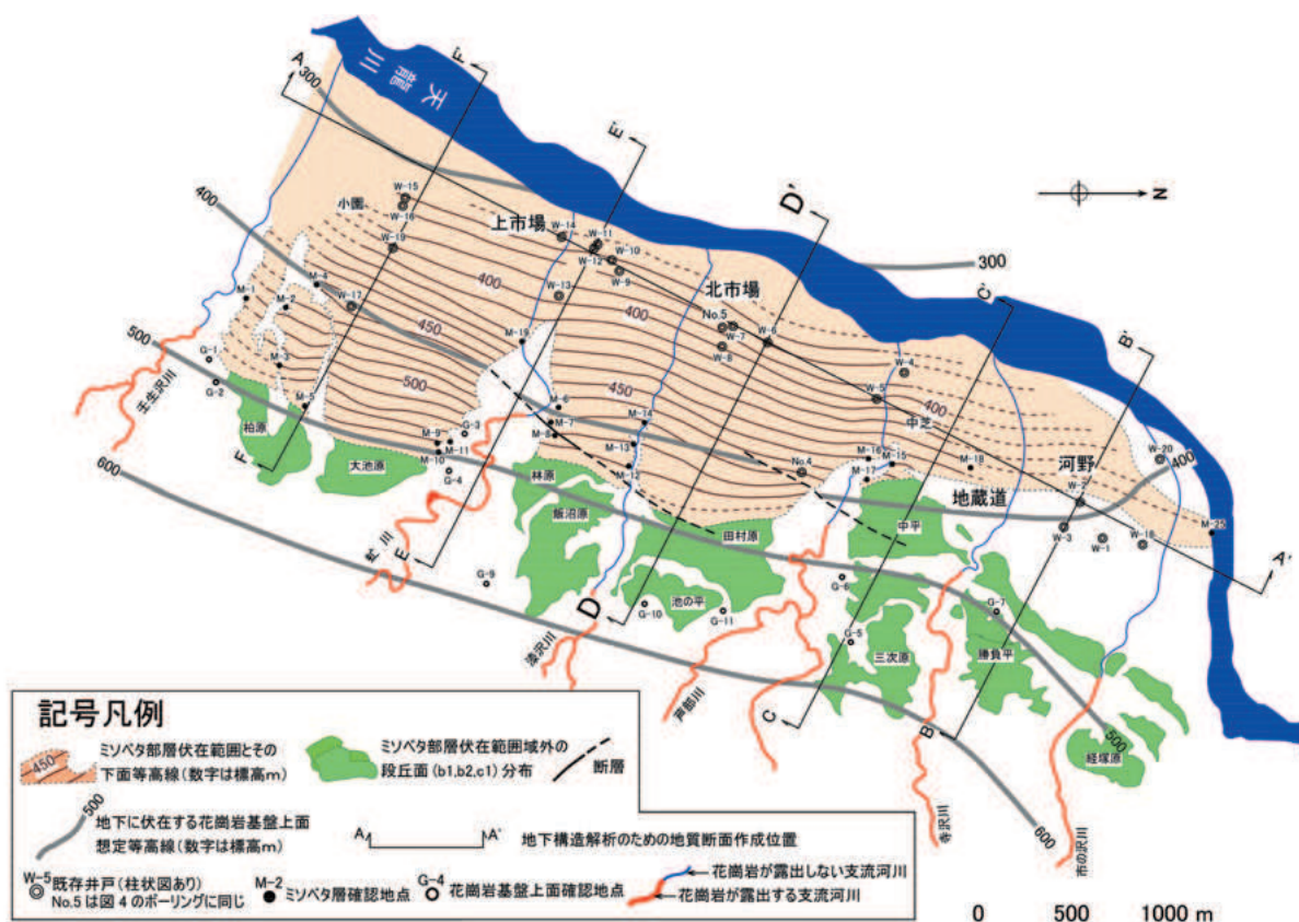
図6 地下に伏在するミソベタ部層の分布を追跡した水理地質構造図
