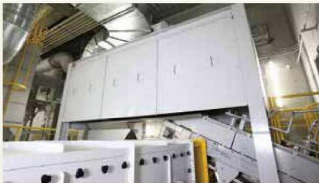
**不燃処理施設用磁選機** Magnetic separator for incombustibles processing
