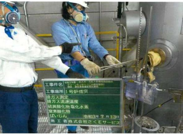
写真 3.1.7 排ガス濃度の監視の様子
