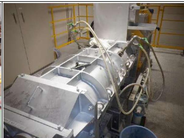
写真 3.12.2 飛灰処理装置の様子
