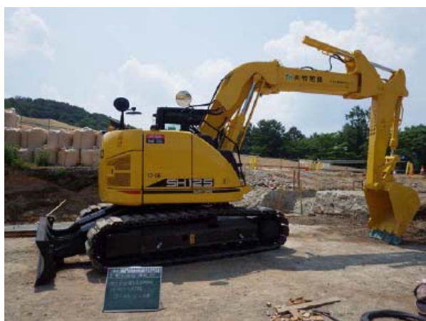
写真 4.1.8 排出ガス対策型建設機器の使用
