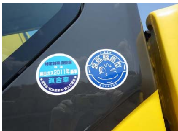
写真 4.1.9 排出ガス対策型建設機器の使用
