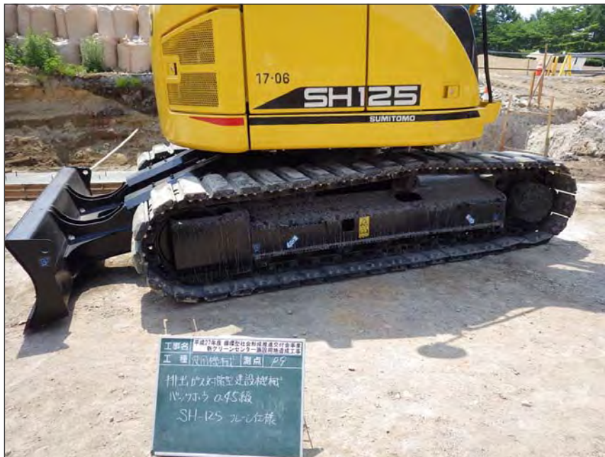
写真区分:環境対策 工種:対策型建設機械の使用 (3) 種別:バックホウ 細別:SH125 写真タイトル:使用機械(排出 ガス対策型・超低騒音型) 撮影箇所:現場にて
