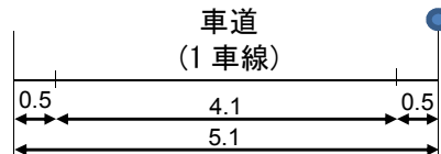
図 5.2-4(2) 山形村道 1 級 2 号線の山形村上大池地区の断面形状 (単位：m)
