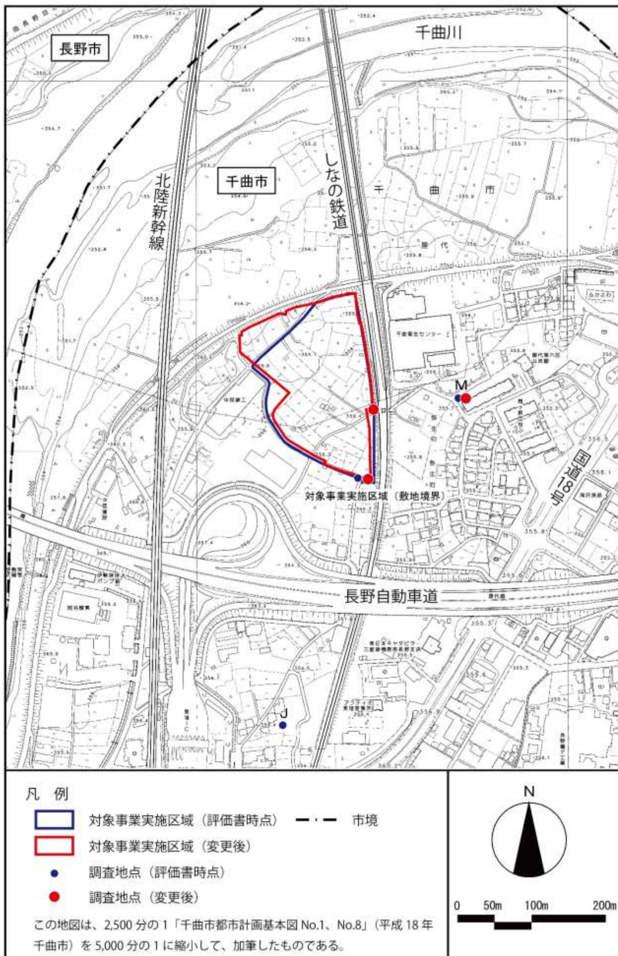
図5-4-2 騒音・振動事後調査地点 (工事による影響)
