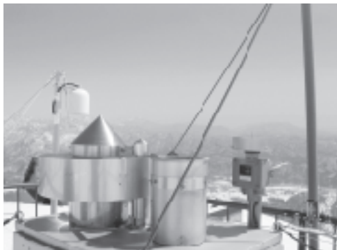
「八方尾根酸性雨測定所の降水自動採取装置」 (降水を感じて蓋が開き、試料を自動採取します)
