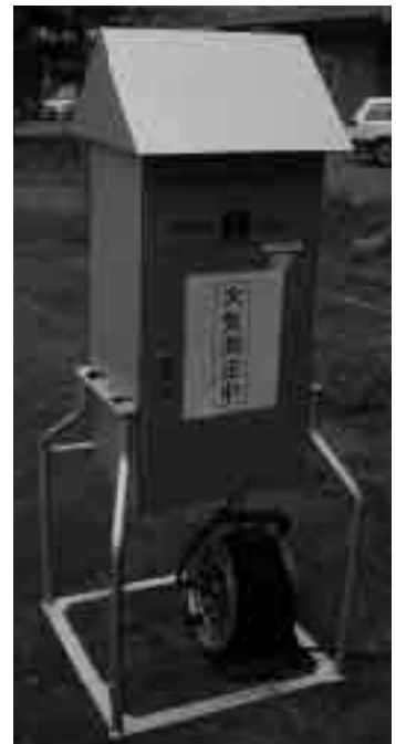
大気中ダイオキシン類を採取する装置。県内約30地点で測定しています。あなたも発見できるかも？
