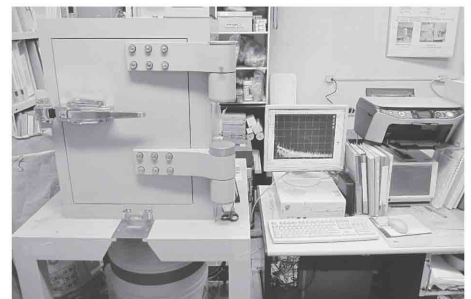
写真3 ゲルマニウム半導体核種分析装置 リング調査も
