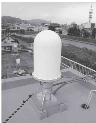
写真1 モニタリングポストの検出器
