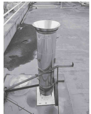
写真4 降下物採取装置
