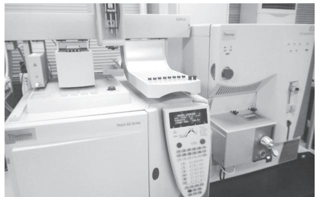
写真 分析法開発に使用しているGC/MS
