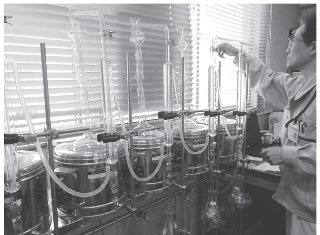
手分析による全シアン蒸留の様子
