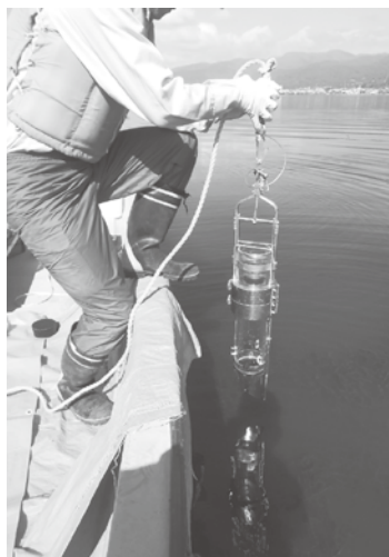
写真1 柱状採泥器による採泥
