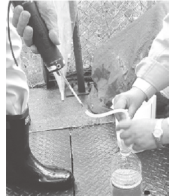
写真 硫化水素の簡易測定
