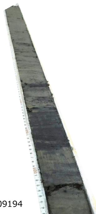
掘削された堆積物コア （掘削長：30.0 m, 最深部の年代：約 2.6 万年前）
