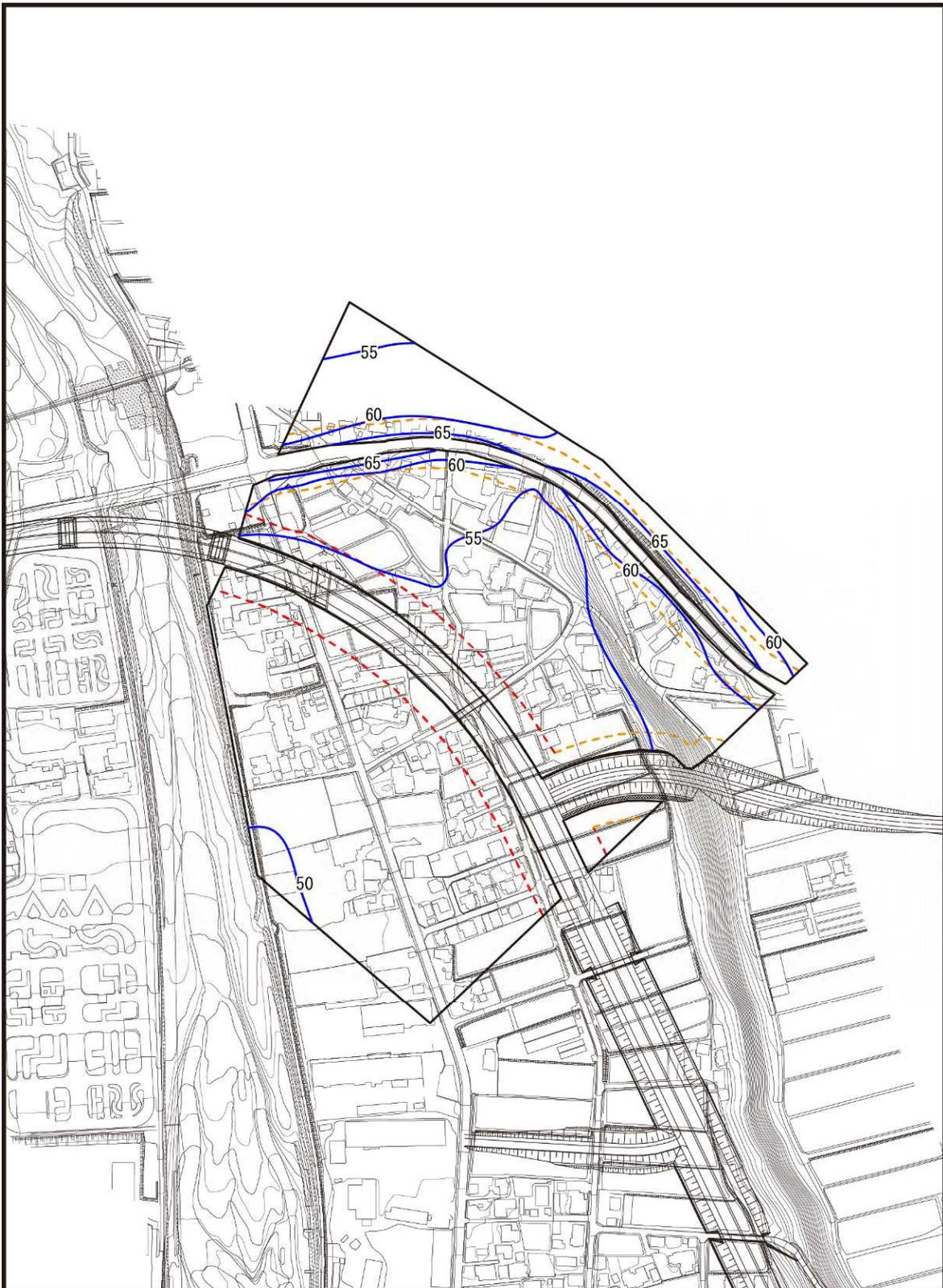
図 3.1-1(2) 自動車の走行に係る騒音分布図(2. 宮田村大田切)1 階屋間
