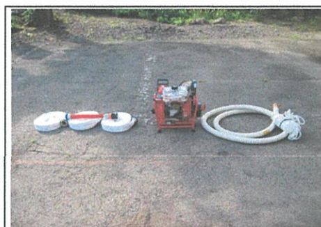
【消防ポンプ 一式】
