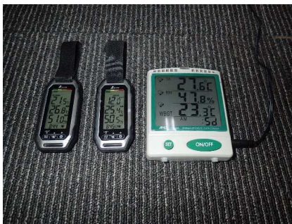
ポータブル簡易熱中症計の携帯 暑さ指数計設置
