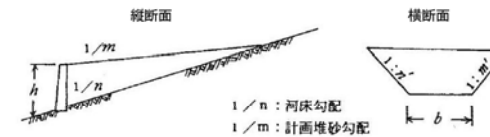
図 9-1-5 概略貯砂量の概念
