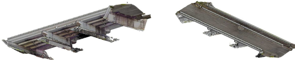
☆ 太郎別当橋 型式：2径間鋼単純H桁橋 橋長 L=36.060m 幅員 W=3.630m
