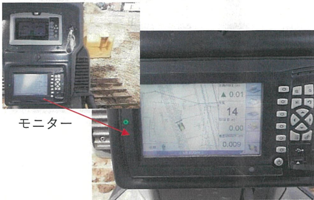
ブルドーザーの位置情報取得後のモニター
