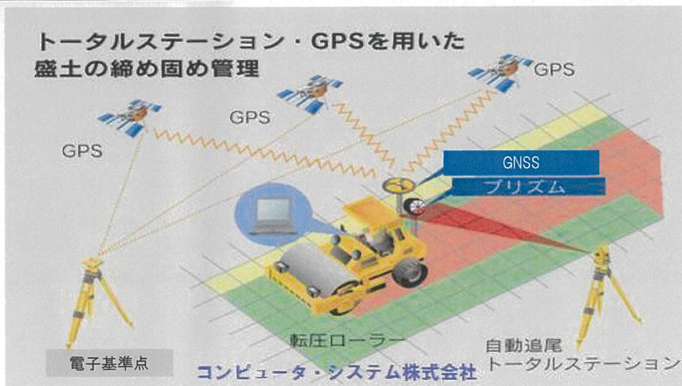
図1.TSとGNSSの概略図
