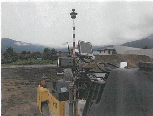
写真③ 機械側のプリズム
