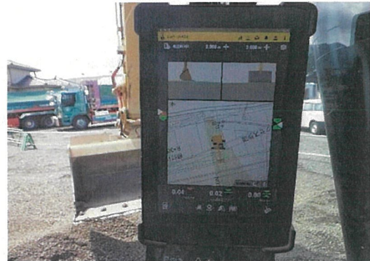
バックホウの位置情報取得後のモニター
