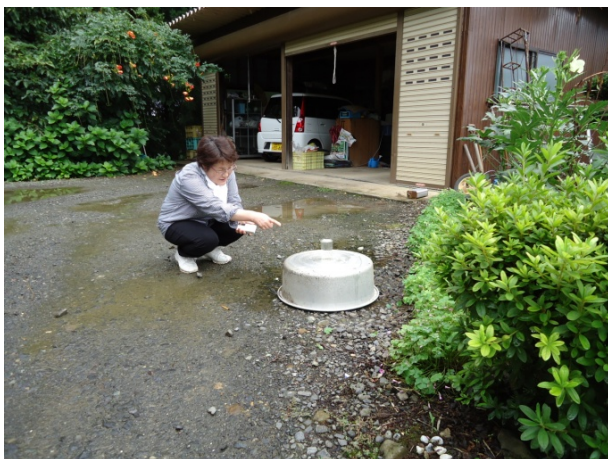
ワンカップ簡易雨量計が溢れたことを確認。「警戒態勢開始」
