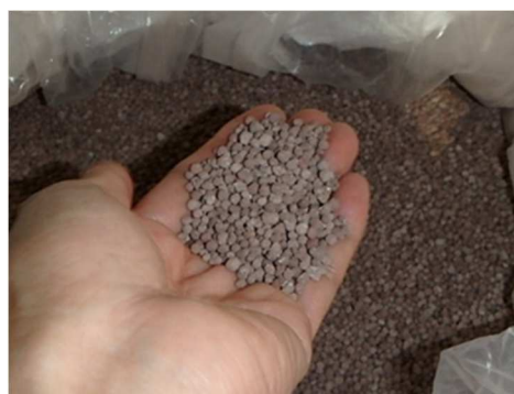
汚泥焼灰から試作した 加工りん酸肥料(リンコレ 15)
