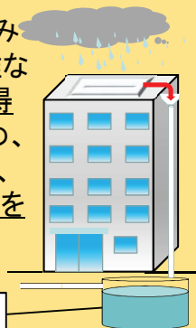
雨水貯留施設
