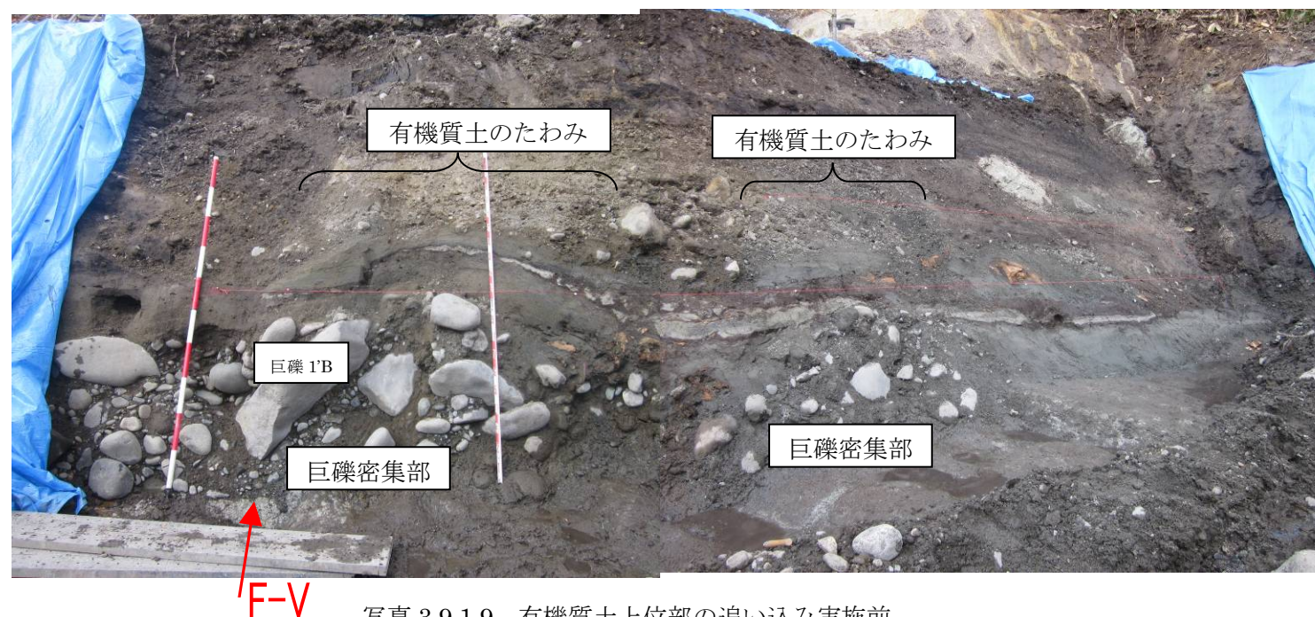
写真 3.9.1.9 有機質土上位部の追い込み実施前 巨礫密集部の直上で、有機質土のたわみが 2 箇所認められる。(11/16 撮影)
