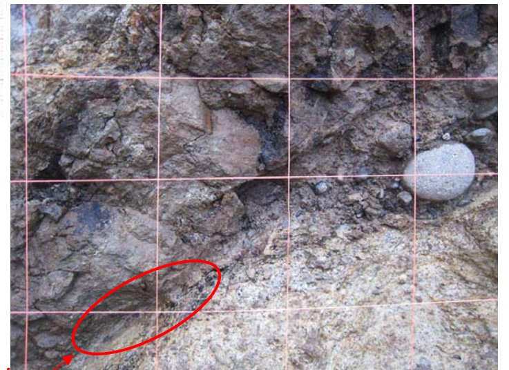
写真 3.6.2.5 断層は左下方で狭くなっており、丸印部では断層面で密着している。
