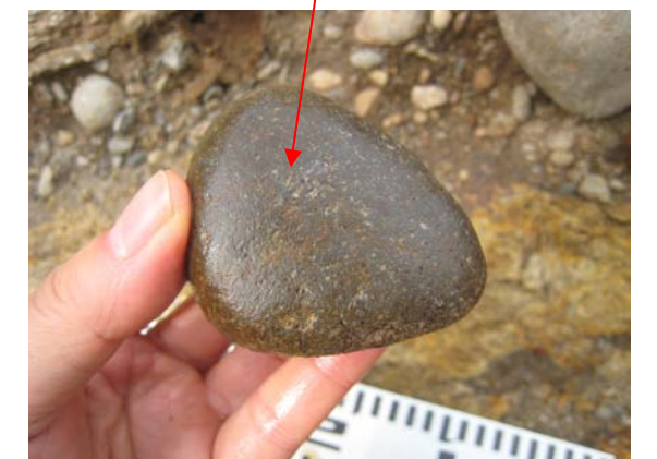
写真 3.6.2.3 F-V 断層面と近接する円礫に擦痕は認められない。
