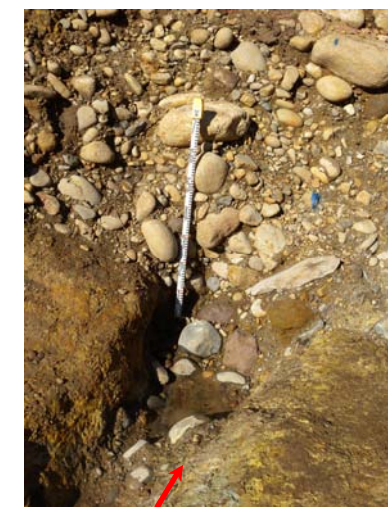
写真 3.5.3 写真 3.5.2 の拡大断層面に擦痕は確認されない。
