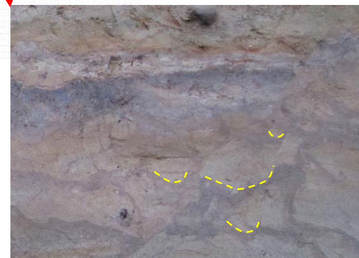
写真 3.6.3.7 下流壁③の右側に認められる不規則な地層の段差。砂層中に介在する有機質の砂層が乱れており、その中に筋状の段差や皿状構造状の下に凸にたわんだ形状(図中の黄線)が認められる。
