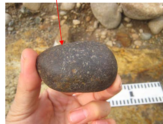
写真 3.6.2.3 F-V 断層面と近接する円礫に擦痕は認められない。
