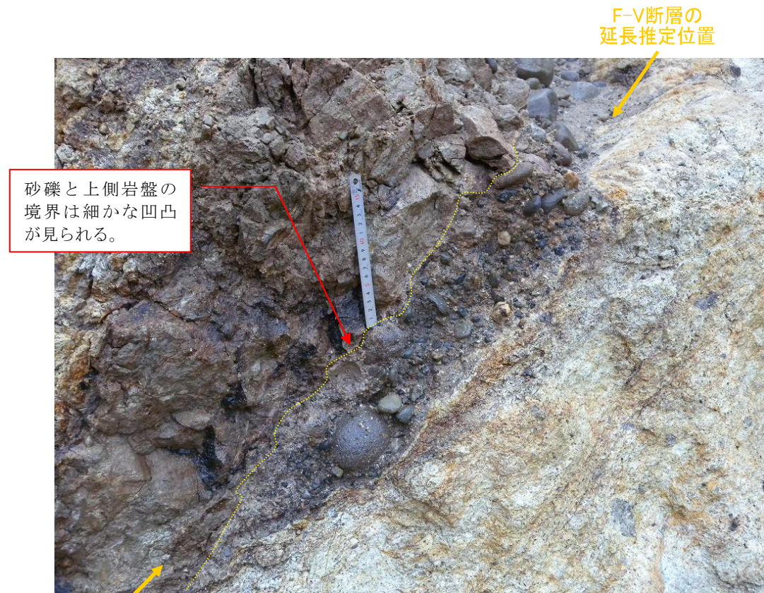
写真 3.6.2.4 F-V断層が円礫を主体とする砂礫により充填されている。断面形状は比較的厚い板状をなす。砂礫の上側岩盤との境界面（黄色点線）には細かな凹凸が見られる。
