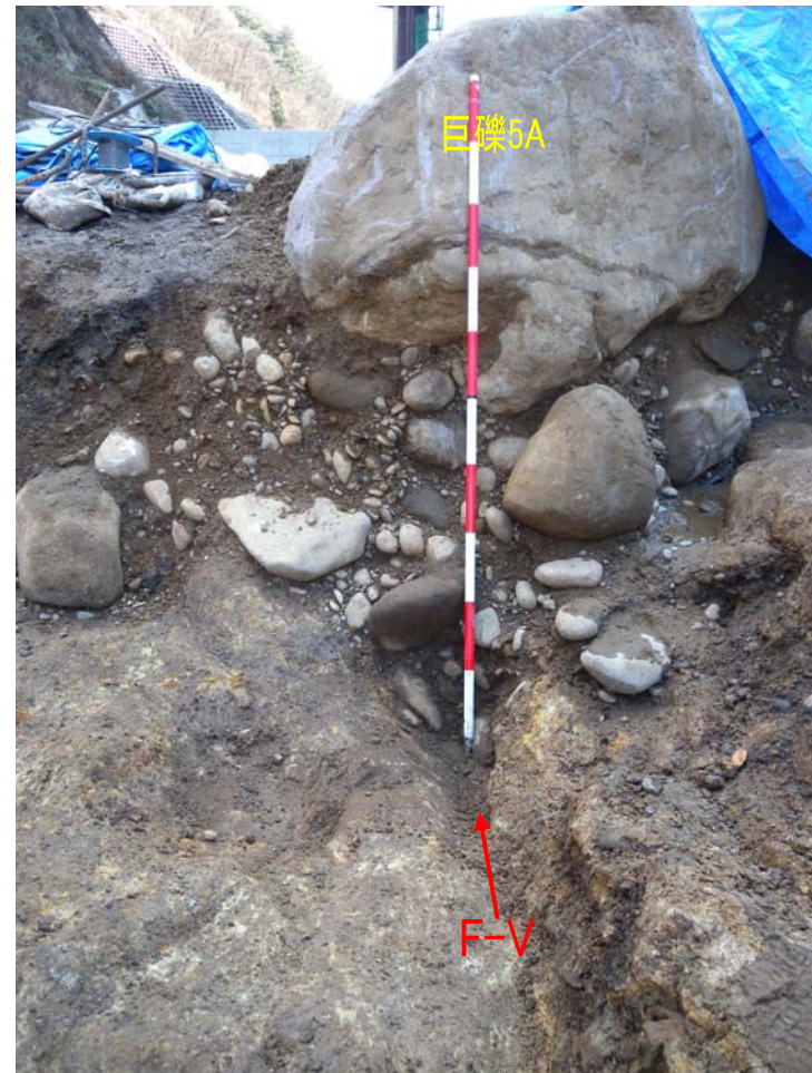
写真 3.6.1.7 トレンチ 5 F-V 断層直上の巨礫付近 (12/11)
