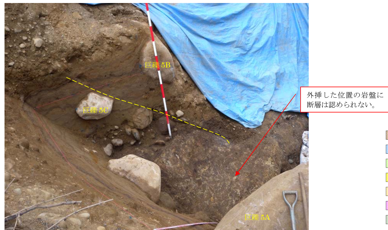
写真 3.6.3.18 黄色線は、山側壁①の段差の面を基盤岩上面に外挿した場合のトレース。有機質土層に認められた段差は基盤岩まで連続していない。さらに、基盤岩中には断層は認められない。
