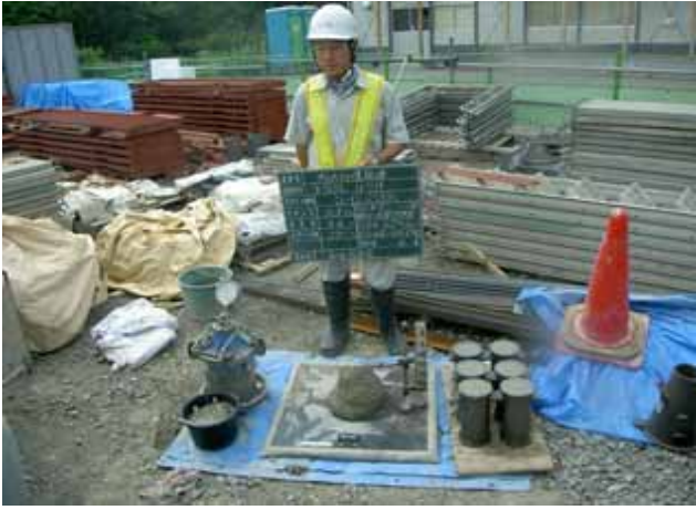
写真 6.1.6 スランブ等立会検査
